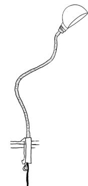
weiß lackierte Aluguß-Klemme, verchromter Stahl-Flexarm, Zuleitungskabel 270cm mit weißem Schnurzwischenschalter, chromatierte Metallfassung mit Außengewinde; Maße: Flexarm Länge 60cm, Klemmweite ca. 0-7cm
